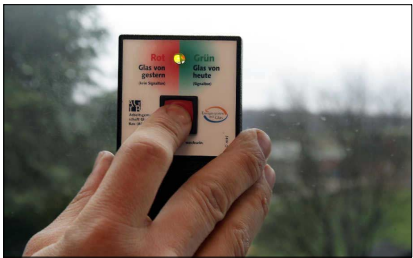
Das Glasmessgerät zeigt den Wärmedurchgangswert eines Fensters an. 1.4 haben neue Isolierglas-Fenster mit einer metallbedämpften Scheibe, 2.9 ältere, gleich aussehende.
